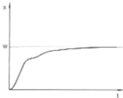
Abb. 55: Regelparameter  $T_n$  und  $T_v$  zu groß
