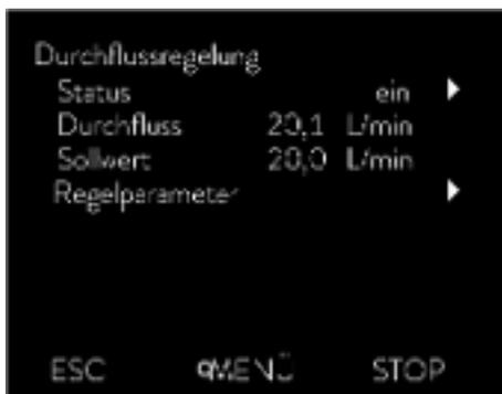
Im Menü → *Module* → *Durchflussregelung* wird unter dem Menüpunkt *Durchfluss* der aktuell gemessene Durchfluss in L/min angezeigt. Zum Einstellen des Sollwerts → Kapitel 5.14 „Durchfluss einstellen“ auf Seite 84.
