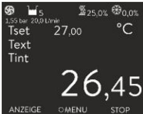
Abb. 45: Grundfenster Integral XT und Integral P mit Durchflussregelung
